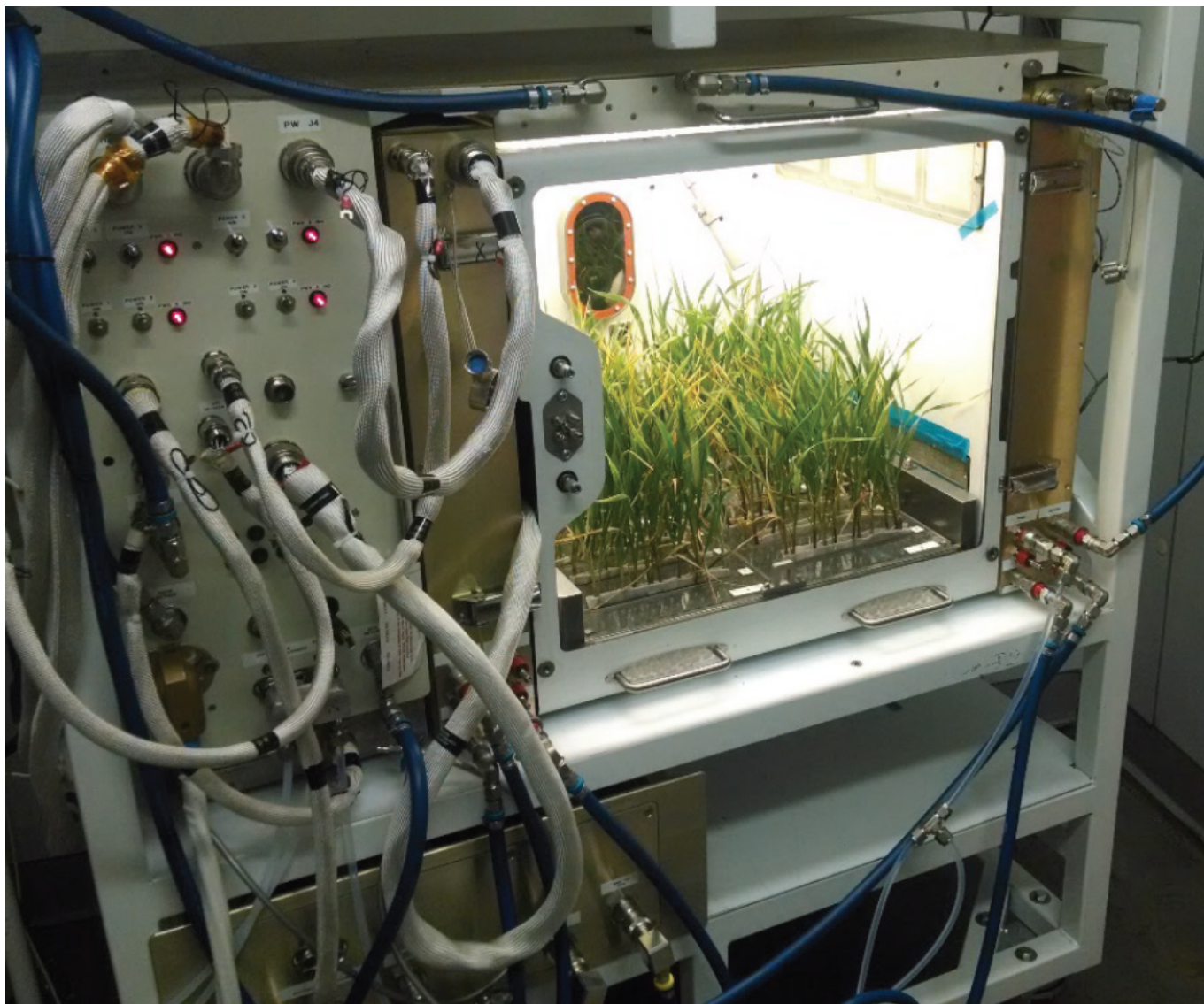
Obr. č. 3 Testovacia jednotka NASA plant habitat (Griffing, Kumar 2019)
